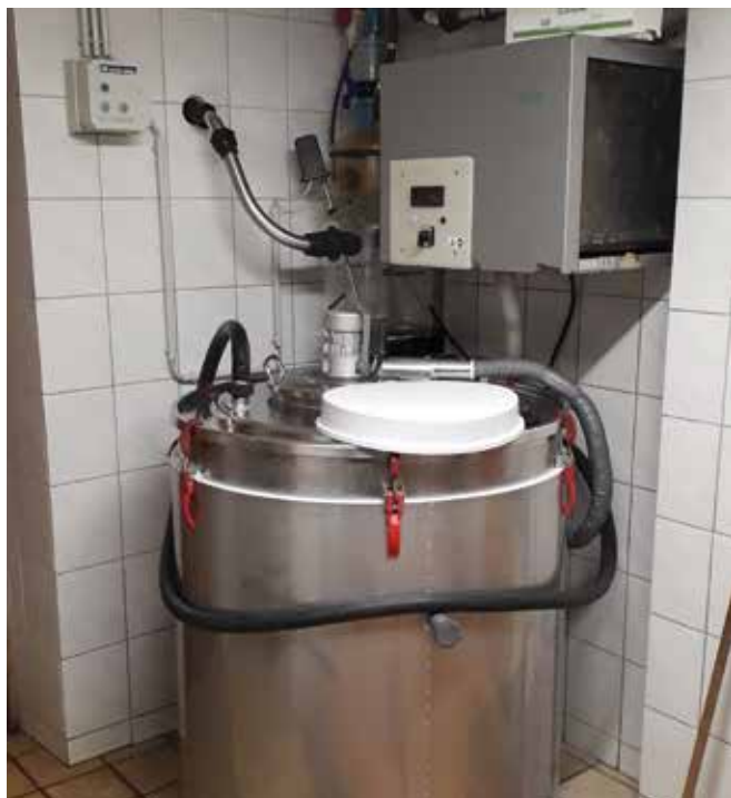
Abbildung 23: Mobiler Milchtank mit elektrischer Milchkühlung (© Lorenz Strickner)
