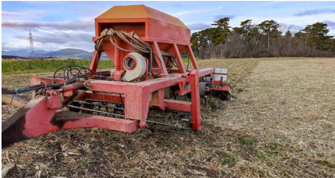
Hier sät Peter Rottensteiner am 12. Dezember 2021 mit der Zinkensämaschine Winterweizen direkt in die Erntereste von Körnermais. Die Erntereste von späträumenden Kulturen lässt der Landwirt am Acker. Sie schützen vor Erosion, weil sie das Wasser zurückhalten, das der gut durchwurzelte Boden aufnimmt und speichert. Fotos: Peter Rottensteiner
