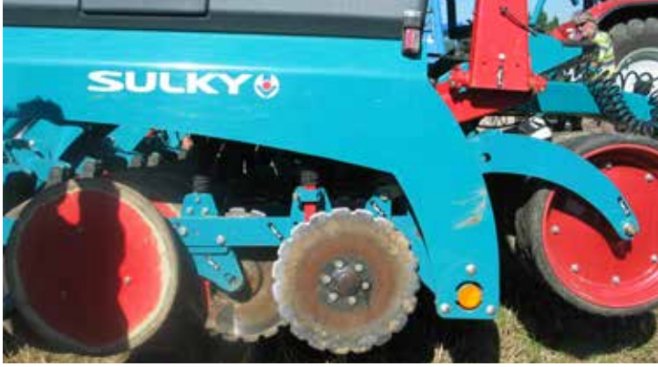
Die Besonderheit der Technik der Sulky Easydrill liegt im Säaggregat, das als Tandemaggregat ausgeführt wird.
