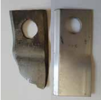
Bild 3: Stark abgenutzte Mähklinnen führen zu einem schlechten Schnittbild. Foto: Wolfgang Turk/LK NÖ
