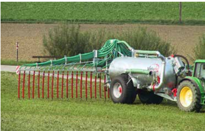
Großes Volumen sorgt für hohe Traglast bei niedrigem Fülldruck. Volumen kann beim Reifen über die Breite und den Durchmesser erzielt werden.
