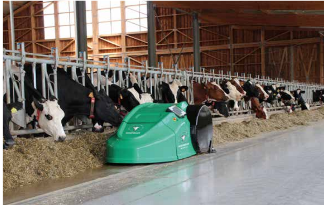
Der Futteranschubroboter „Wasserbauer Butler Gold“ durchmischt durch den angebauten Schneckenförderer das Futter am Futtertisch und legt es frisch vor, wodurch die Attraktivität für die Tiere zunimmt.
