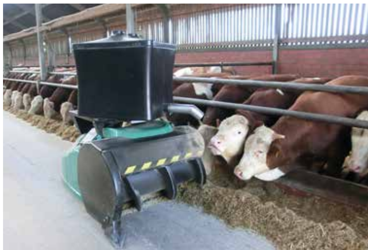
Auch in der Rindermast wird der Futteranschubroboter eingesetzt. Dieses Modell verabreicht darüber hinaus eine Lockfuttermenge mit Kraftfutter.
