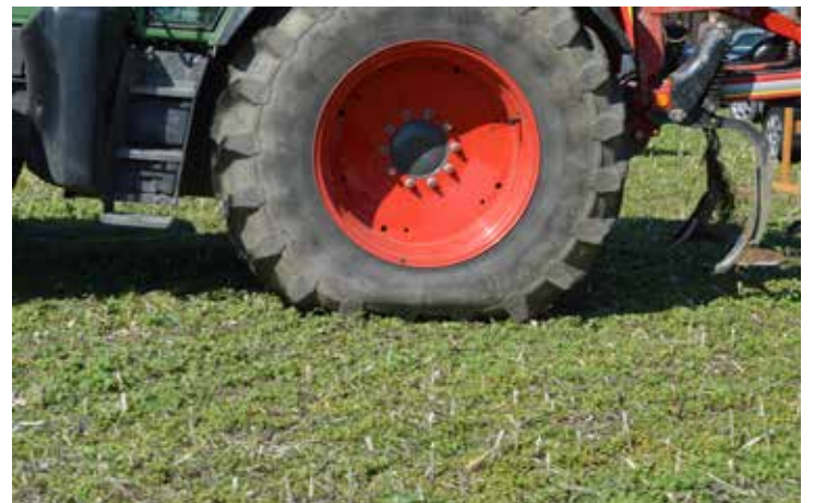
Wird auf dem Feld mit niedriger Fahrgeschwindigkeit gearbeitet, macht es bei Radialreifen Sinn, den Fülldruck auf das notwendige Maß zu reduzieren.
