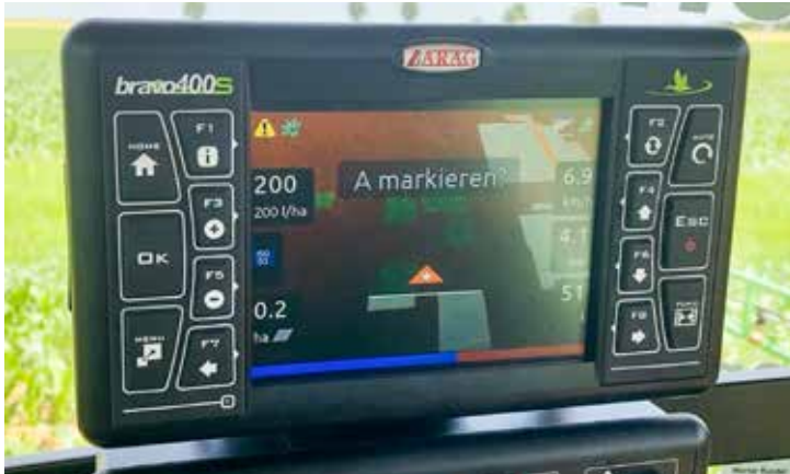
Die Applikationskarte wurde per USB-Stick in den Bravo 400 S eingespielt, der die Karte bei der anschließenden Überfahrt durch automatisches Schalten der Teilbreiten abarbeitete.
