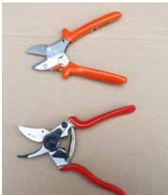
Im Gegensatz zur Bypass- (unten) darf man die Ambossschere nur für die Trockenastung verwenden.
