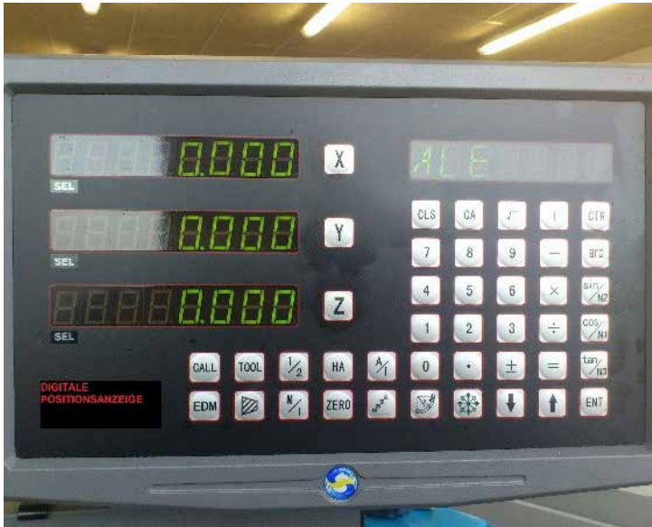
Auf der Digitalanzeige sieht man die Werkstückabmessungen, den Materialabtrag und die Drehmesserposition.
