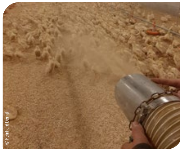
Abb. 129: Halb automatisches Einstreuen mit Strohmatic Air
