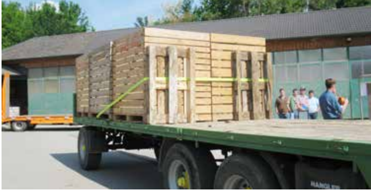
Damit der Gurt in der richtigen Höhe bleibt, kann man sich zum Beispiel mit Paletten helfen. Fotos: Christoph Wolfesberger/LK NÖ
