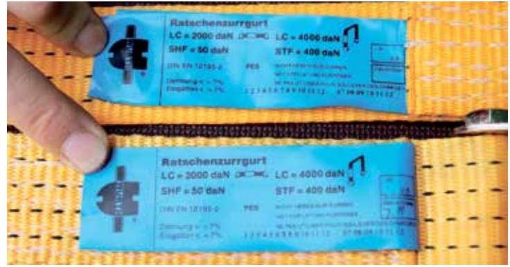
Für den Einsatz sind beim Gurt die Angaben auf dem Etikett maßgebend. Fehlt das Etikett, ist der Gurt wertlos.
