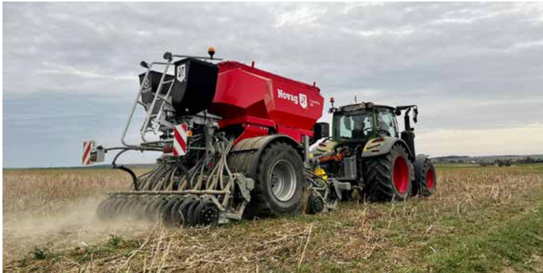
Die Direktsämaschine legt das Saatgut genau zwischen den Ernteresten ab. Der Traktor fährt exakt in den von Franz Winkelhofer programmierten Spuren. Wichtig dabei ist, dass die Unterlenker kein Spiel haben, sonst nutzt das genaueste Spurführungssystem nichts. Die Unterlenker müssen genau in der Mitte zentriert sein. Fotos: Franz Winkelhofer
