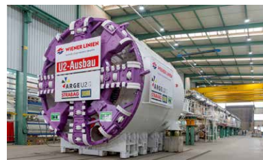
Die TVM wird sich mit einer Antriebsleistung von 1,92 Megawatt durch Wien graben
